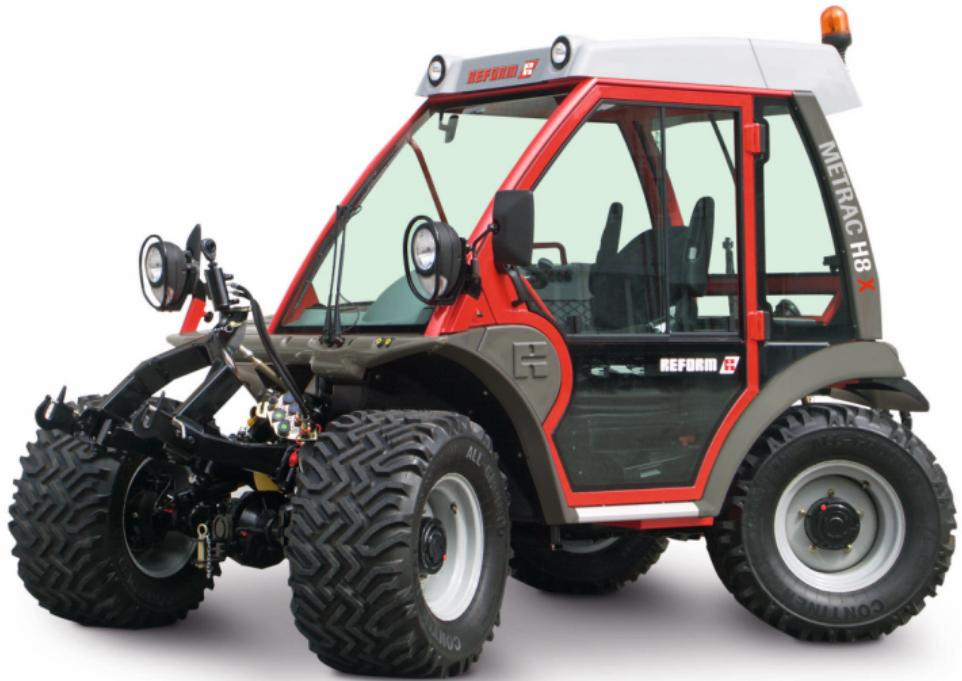
Motor má výkon 81,5 PS. Tato hnací síla umožňuje připojit nejen široké mulčovače, ale i například čelní frézu určenou k drcení pařezů.
